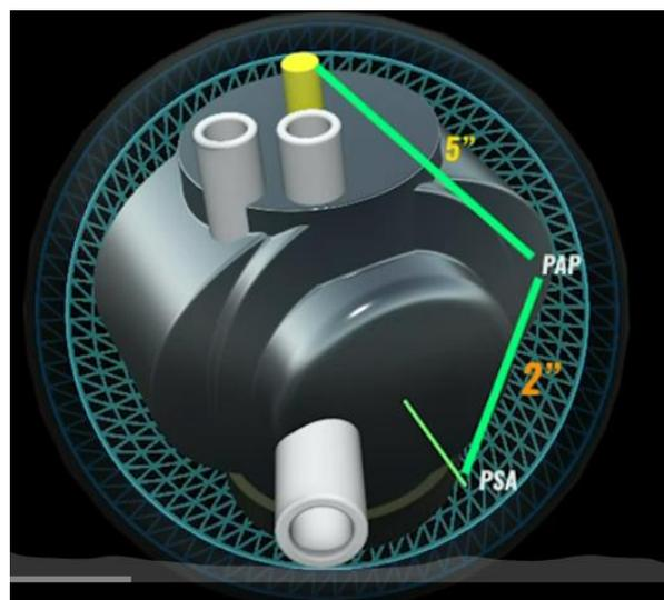
Diese bevorzugte Drehachse nennt man PSA.
